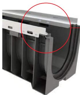
Zaštitni rub XtraLine S kanala od pocinčanog ili nehrđajućeg čelika izložen prelazu vozila, visine je 20 mm i debljine 2,5 mm. Zaštitni rub služi za siguran dosjed rešetke i omogućava jednostavnu montažu rešetke u kanalu.
