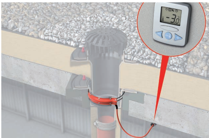
Dvodijelni Spin slivnik za ravne krovove sa grijačem (Art.br. 7000.85.00) i termostatom (ugradnja na licu mjesta)
