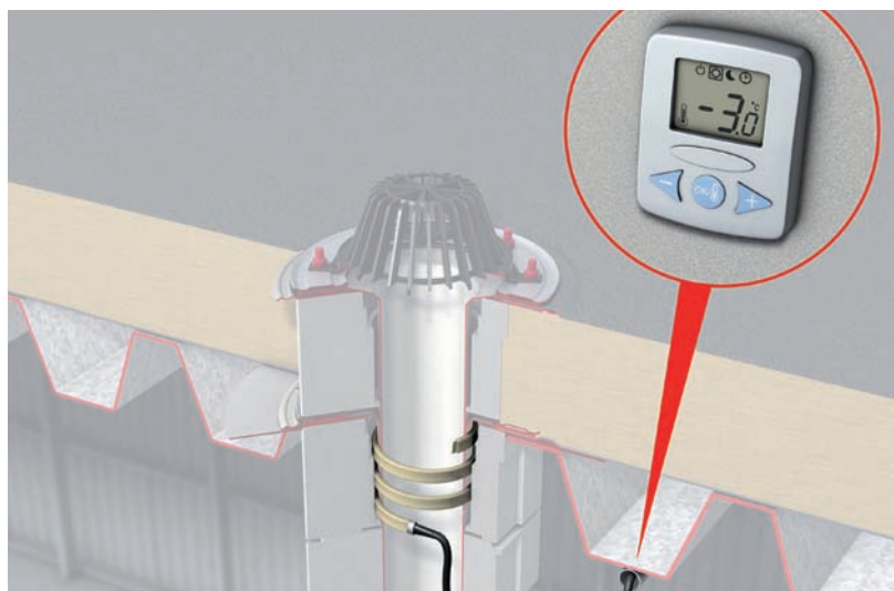
Dvodijelni Spin slivnik za ravne krovove sa grijačem (Art.br. 0174.84.32) i termostatom (ugradnja na licu mjesta)
